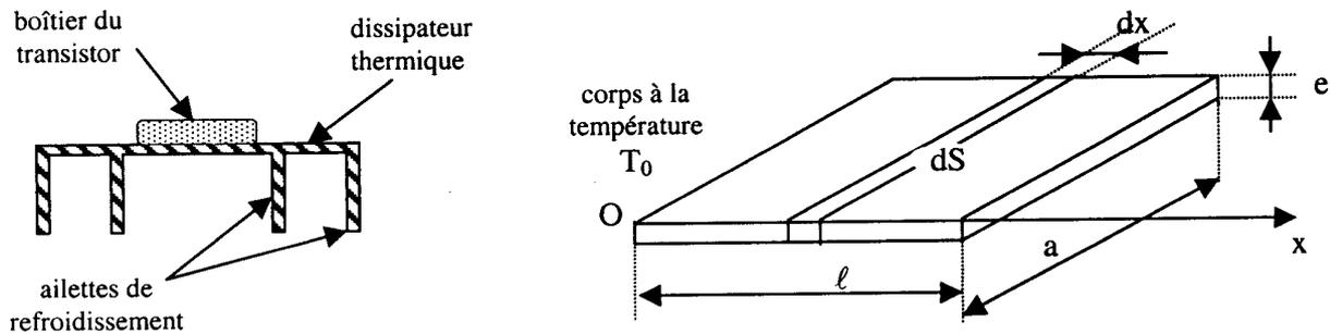
Une ailette de refroidissement en aluminium de conductivité thermique  $\lambda = 200 \text{ W m}^{-1}\text{.K}^{-1}$  est fixée à un corps dont la température est  $T_0 = 70^\circ\text{C}$  constante et baigne dans l'air ambiant dont la température est constante et vaut  $T_a = 20^\circ\text{C}$ . Le corps à la température  $T_0$  occupe le demi-espace  $x < 0$ .
