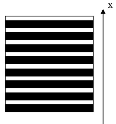
a) On considère que les transferts thermiques s'effectuent seulement selon la direction  $Ox$ . Déterminer la résistance thermique  $R_1$ , d'une épaisseur  $e$  du matériau, de surface  $S$ , constituée de  $N$  empilements plaque-carte. En déduire que l'empilement est équivalent à une épaisseur  $e$  d'un matériau homogène de section  $S$ , dont on exprimera la conductivité thermique  $\lambda$  en fonction de  $\lambda_1, \lambda_2, e_1$  et  $e_2$ .
