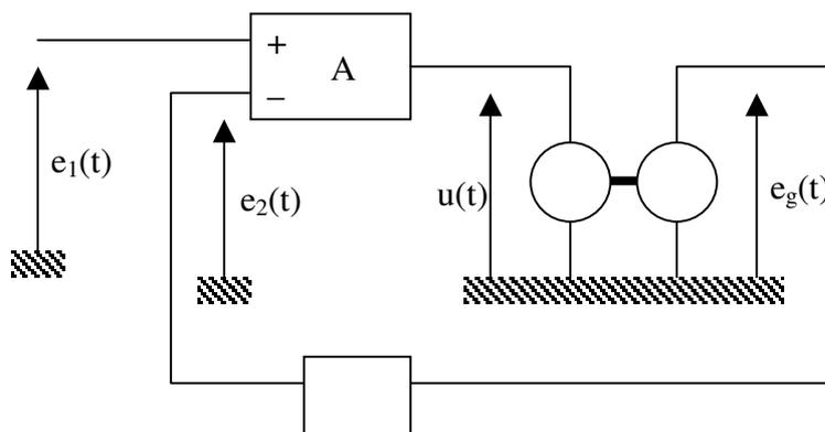
Le moteur, chargé, est inséré dans une boucle de régulation suivant le schéma ci-dessus. Il est couplé à une génératrice tachymétrique GT qui fournit une tension  $e_g = k_g \cdot n$  et à un ampli réalisant  $e_2 = a \cdot e_g$ .
