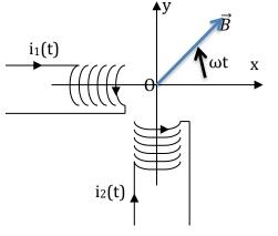
Un aimant placé en 0 est entrainé en rotation par le champ ; c'est le principe du moteur synchrone.
