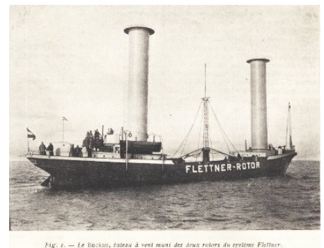
Fig. 1. — Le Bucken, bateau à vent muni des deux rotors du système Flettner.
