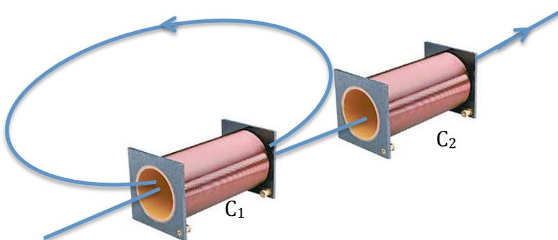
Le champ magnétique  $\vec{B}_1$  créé par  $i_1(t)$  flue (totalement ou partiellement) à travers le circuit  $C_2$ , créant un flux  $\Phi_{1 \rightarrow 2}$  proportionnel à  $i_1(t)$ .
