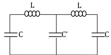
Réponse : b)  $\omega_1 = \frac{1}{\sqrt{LC}}$  ;  $\omega_2 = \sqrt{\frac{C'+2C}{LCC'}}$ .
