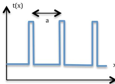
Cet objet se décompose en une superposition de mires sinusoïdales identiques à celle qui vient d'être étudiée.
