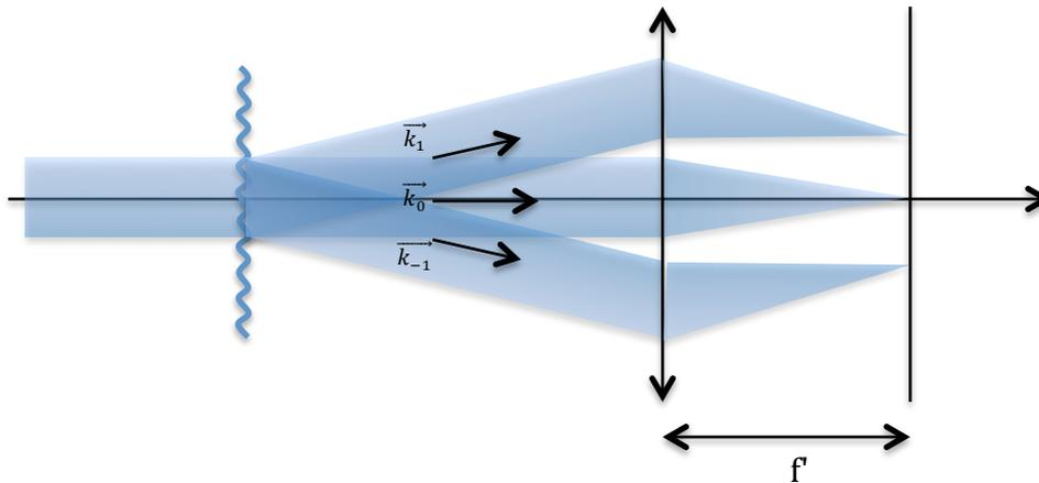
Dans le plan de Fourier on observe donc une répartition lumineuse déterminée par le spectre de Fourier complexe du coefficient de transparence  $t(x)$  :
