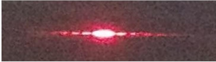
Dans le plan de Fourier on observe une tache principale de diffraction d'autant plus large que la fente est fine conformément à la relation admise en première année :
