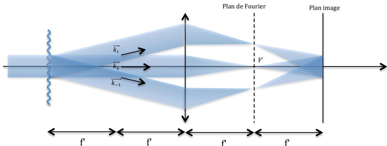
On place un diaphragme dans le plan de Fourier pour filtrer l'image :
