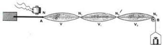
La corde entre en résonance lorsque ω est l'une des pulsations propres de la corde, soit :
