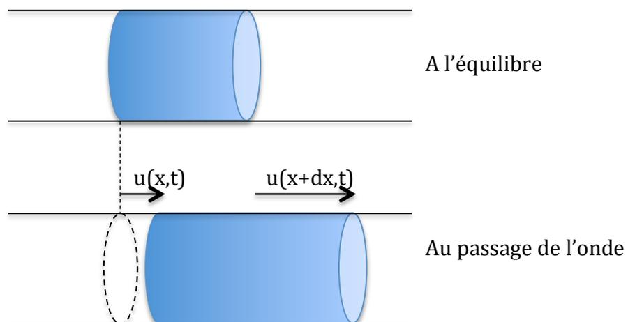
L'allongement de ce petit élément est  $du = u(x+dx,t) - u(x,t) = \frac{\partial u}{\partial x} \cdot dx$
