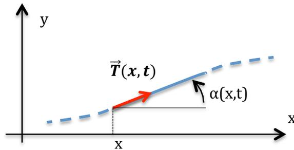
Les mouvements de la corde sont transversaux et petits ; en appelant  $\alpha(x,t)$  l'angle entre la corde et l'horizontale, on a, à l'ordre le plus bas :
